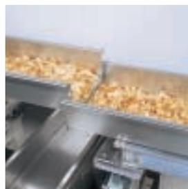
HDCGのトラフの振動中心が移動する
